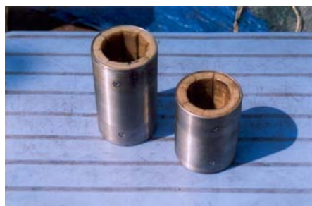
Hình 2. Cặp bạc lót trục chân vịt và tàu cá KH5390TS của Võ Văn Mãi
