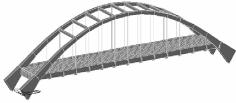
Hình 4 : Mô hình cầu vòm
