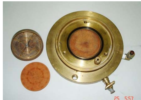
Hình 5: Cấu tạo của vòng cao su và đá thấm, đá thấm được mang ra ngoài loading cap
