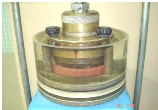
(b) Hộp cố kết sau khi lắp hoàn chỉnh Hình 1 - Hộp cố kết của hãng Controlab
