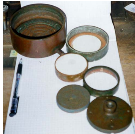
Hình 3: Hộp cố kết xuất sứ từ Trung Quốc
