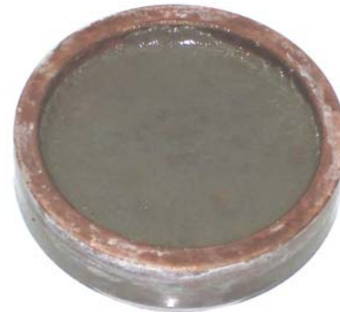
Hình 11: Đất bị đẩy tràn lên thành của vòng cố kết của hộp cố kết kiểu thương mại
