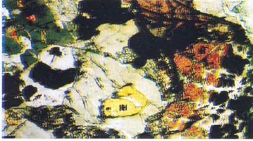
Hình 3a: Granit bị phong hoá và nứt nẻ mạnh
