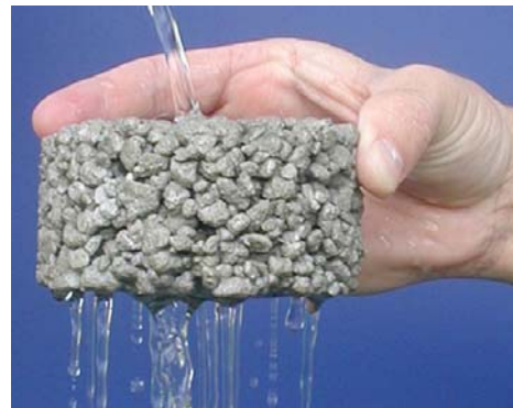
Hình 1: Nước thoát qua các lỗ rỗng
