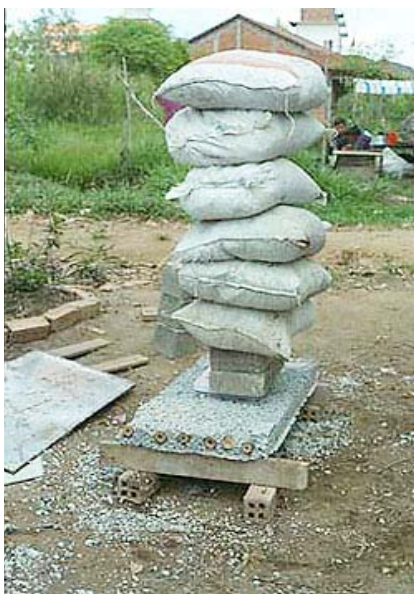
Hình 5: Panel Bê tông rỗng cốt liệu nhẹ dùng gỗ hoặc tre gia cường
