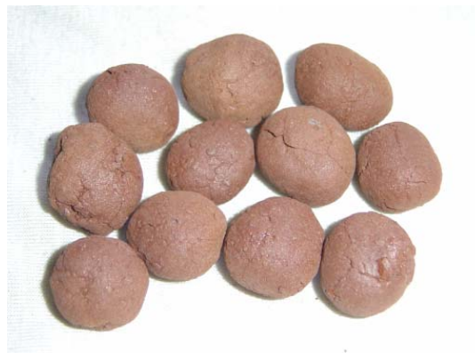
Hình 9: Hạt keramzit tạo thành có độ phồng nở cao, pha thủy tinh vừa phải tạo độ dính bám tốt với đá xi măng, độ hút nước thấp.
