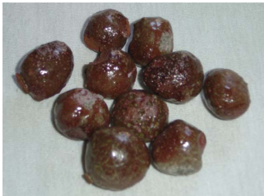
Hình 8: Hạt keramzit tạo thành với lớp thủy tinh bọc bên ngoài làm tăng cường độ chịu nén của hạt, đồng thời có độ hút nước thấp
