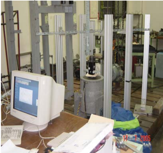
Hình 6: a/ Mô hình thật để đo tần số tự nhiên. b/ Tiến hành đo đặc các thông số.
