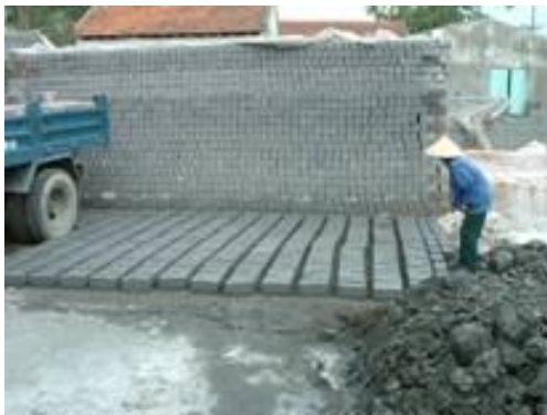
Hình 6: Sử dụng tro xỉ than một cách tự phát làm gạch xây nhà, sân phơi...
