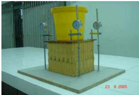
Hình 1: Hình ảnh 3 mẫu thí nghiệm và sự gia tải trên mẫu.
