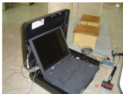
Hình 3: Thí nghiệm xác định tần số dao động riêng của mô hình.
