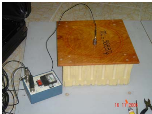
Hình 3: Thí nghiệm xác định tần số dao động riêng của mô hình.
