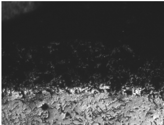
Hình 12 : Mẫu gang xám được thấm bo điện phân trong 70 % borax + 30 % acid boric . Nhiệt độ thấm 1050 °C ; thời gian 1 giờ 30 phút ; mật độ dòng 0,4 A/ cm 2 và đảo chiều . Độ phóng đại 50x . Chiều dày lớp thấm : 0,23 mm
