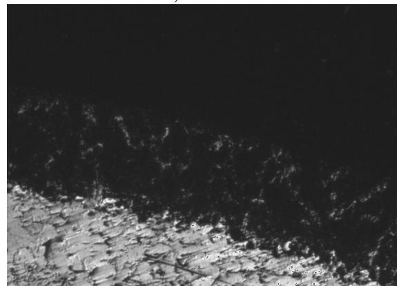
Hình 5 : Mẫu thép CT38 ( C T 3 ) được thấm bo điện phân trong 70 % borax + 30 % acid boric . Nhiệt độ thấm 950 °C ; thời gian 2 giờ ; mật độ dòng 0,4 A/ cm 2 và đảo chiều. Độ phóng đại 50x . Chiều dày lớp thấm : 0,26 mm
